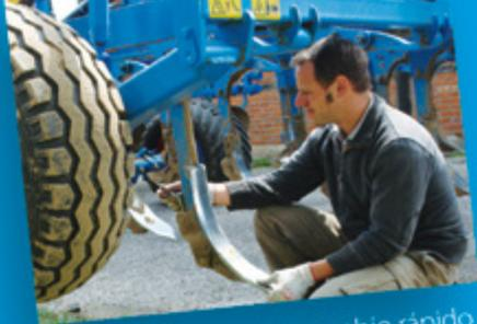
El sistema opcional de cambio rápido permite al Karat adaptarse a una gran variedad de condiciones de trabajo sin utilizar ninguna herramienta.
