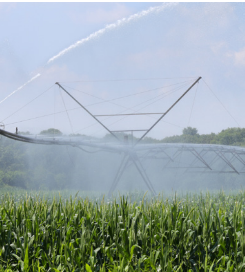
► Riego de un cultivo de maíz mediante un sistema de pivot.
